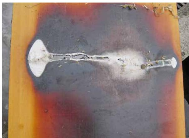
*Noircissement des panneaux infrarouges en raison du vieillissement et endommagement.*
