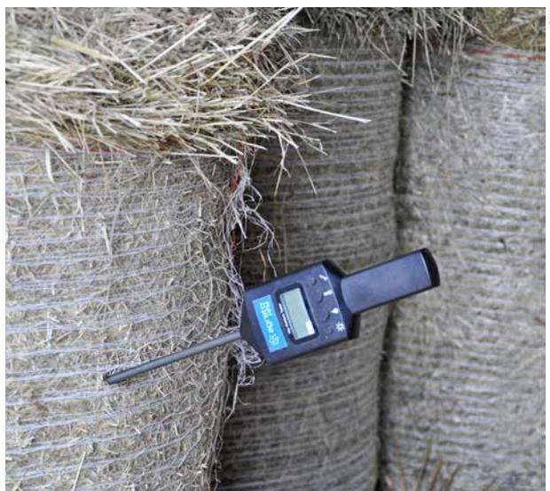
Sonde de température pour la mesure de la température centrale.
